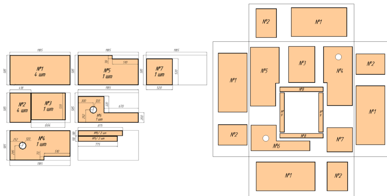
Рисунок 7 – Карта раскроя утеплителя
